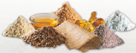
Die Bestandteile von Linoleum
